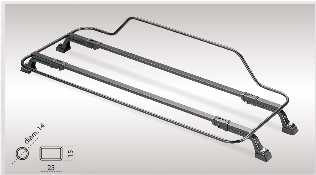
Portabagagli per cofani posteriori. Realizzato interamente in profilato d'acciaio, verniciato con polveri termoindurenti "long life" anticorrosione. Disponibile anche in acciaio inox cromato. Supporti/ attacchi con larghezza regolabile. OPTIONAL: blocchetti per portasci.
