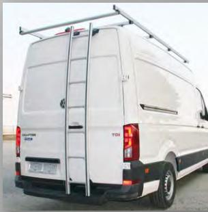
NUOVA scaletta posteriore in alluminio, fissaggio senza foratura.
