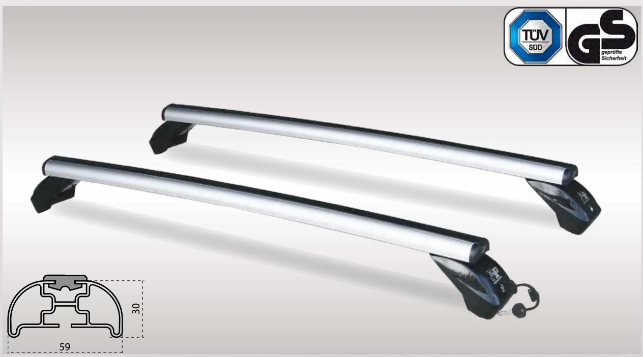
LP 56: portatutto con solida struttura portante in lega d'alluminio. Piano di carico rivestito in PVC antiscivolo-antigraffio. Attacchi in lamiera d'acciaio stampata e verniciata con polveri termoindurenti "long life" anticorrosione.
