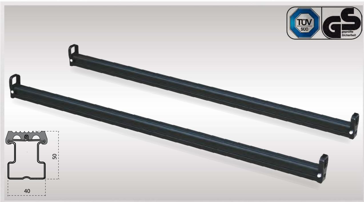
Portatutto per veicoli commerciali. Solida struttura portante in profilato d'acciaio. Piano di carico rivestito in PVC antiscivolo-antigraffio e dotato di occhielli per aggancio. Supporti e attacchi, regolabili in larghezza e in altezza, realizzati in lamiera d'acciaio stampata e verniciata con polveri termoindurenti "long life" anticorrosione.
