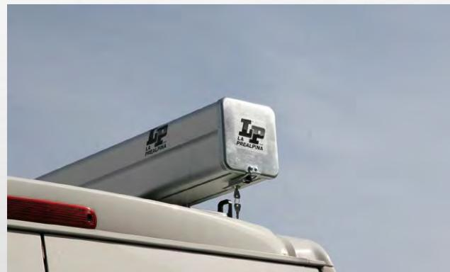
Tubo porta profili per barre portatutto ad uso professionale. In alluminio anodizzato, con tappo anteriore e apertura posteriore realizzati in lamiera zincata. Chiusura con serratura di sicurezza. Ideale per il trasporto di tubi e canaline.
