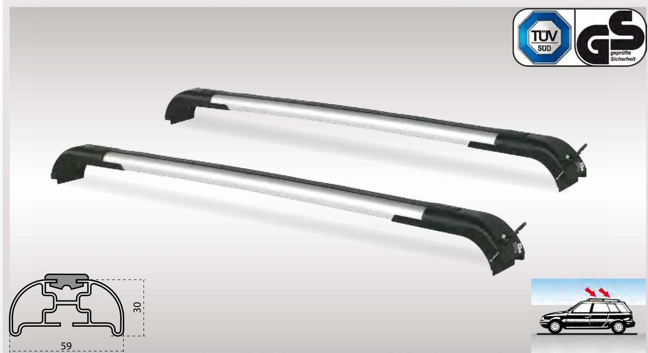
Portatutto universale per railing. Struttura portante in alluminio anticorrosione, aerodinamica e maneggevole. Piano di carico rivestito in PVC antiscivolo-antigraffio. Attacchi in lamiera d'acciaio stampata e verniciata con polveri termoindurenti "long life" anticorrosione. Terminale copri-attacchi realizzato in ABS e dotato di serratura con chiave.
